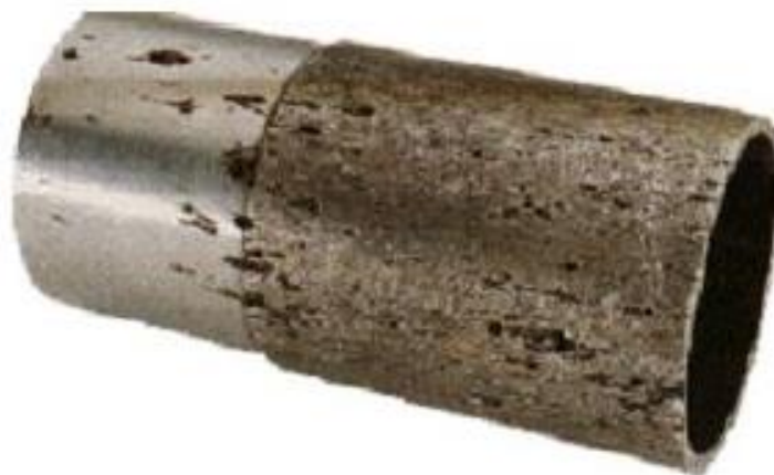
Figure I.5 : Corrosion par piqûres d'un acier inoxydable.
