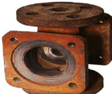
Figure I.1 : Corrosion générale (rouille) d'une pièce en acier.
