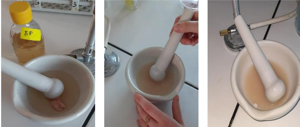
**Photo 9** : Broyage de l'échantillon de viande en vue de l'obtention de la solution mère.
