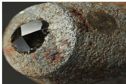
Figure 2.6: Indenteur en diamant de forme pyramidale de 136^\circ [63]
