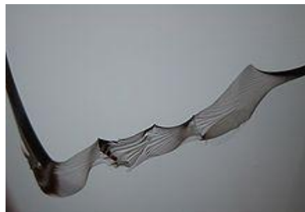
Figure 1.2 : Faciès de rupture fragile (verre)[3]
