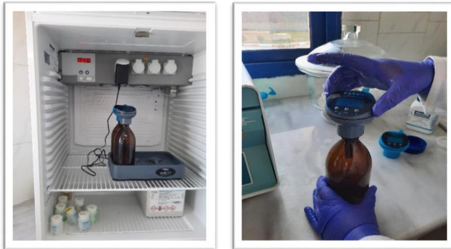
**Figure 02 :** DBO mètre (laboratoire de la STEP de Ain Taghrout 2022)
