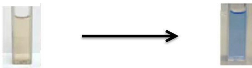
Figure 7. Changement de couleur due à une réduction du molybdat d'ammonium (Jaune) par le noyau phénol (Bleu) (Agbor et al., 2014).
