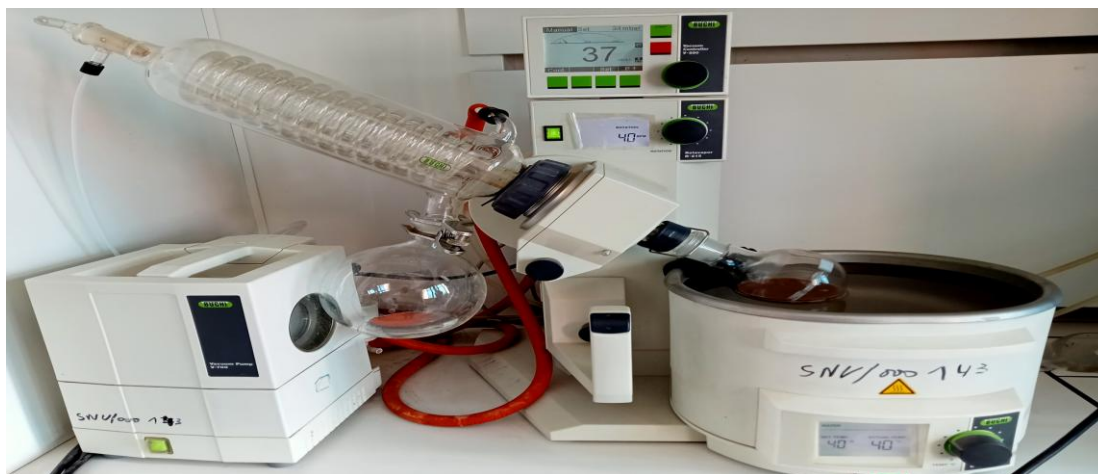
Figure 5. Evaporation du solvant au Rotavapeur
