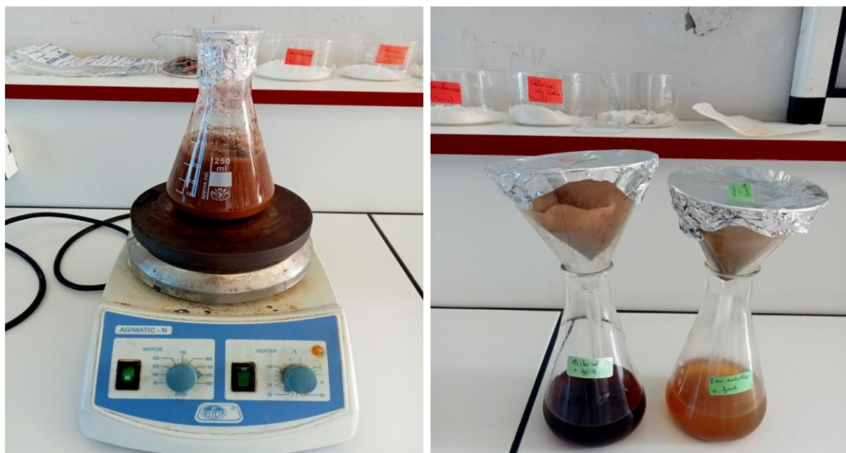
Figure 4. Extraction par macération à l'aide d'un solvant méthanolique
