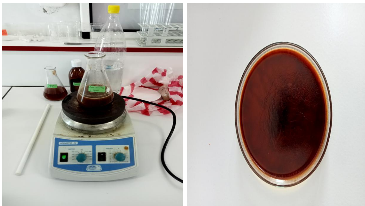
Figure 6. Extraction par décoction à l'aide d'eau distillé
