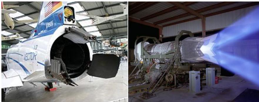
**Fig. 1** a) Réacteur de l'avion de Rockwell-MBB X-31 capable de réaliser une poussée vectorielle tridimensionnelle. b) Moteur d'avion F-22 est capable de produire deux poussées vectorisées, [United Technologies Corporation – Pratt & Whitney Division].
