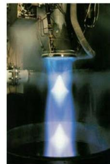
**Figure I.23 :** a) Réflexion régulière [Document d'Onera]. b) Visualisation strioscopique de la réflexion régulière ; RL10-A5, écoulement de sous-détente avec réflexion régulière apparente [17]
