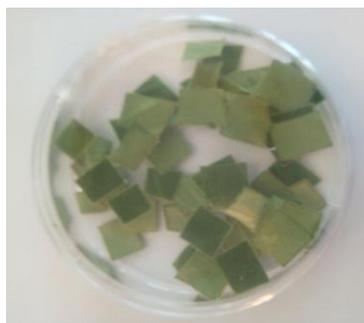
**Figure 6.** Coupage des échantillons en segments 5\*5mm
