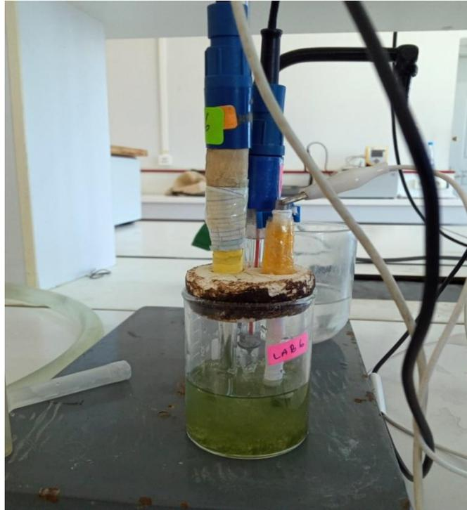
**Figure II.6** : montage a trois Electrodes
