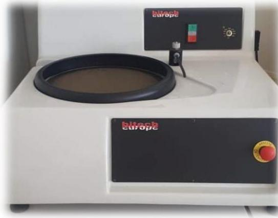
**Figure II.2 :** machine de polissage mécanique
