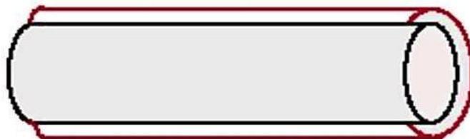
**Figure 10 :** Schéma d'un polymère imprégné d'agent antibactérien par dépôt.
