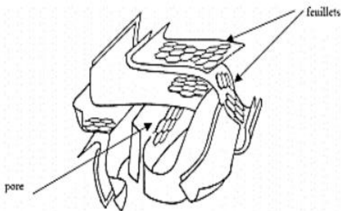
Figure II. 6. Unité structurale de base (USB) d'un charbon actif [37].
