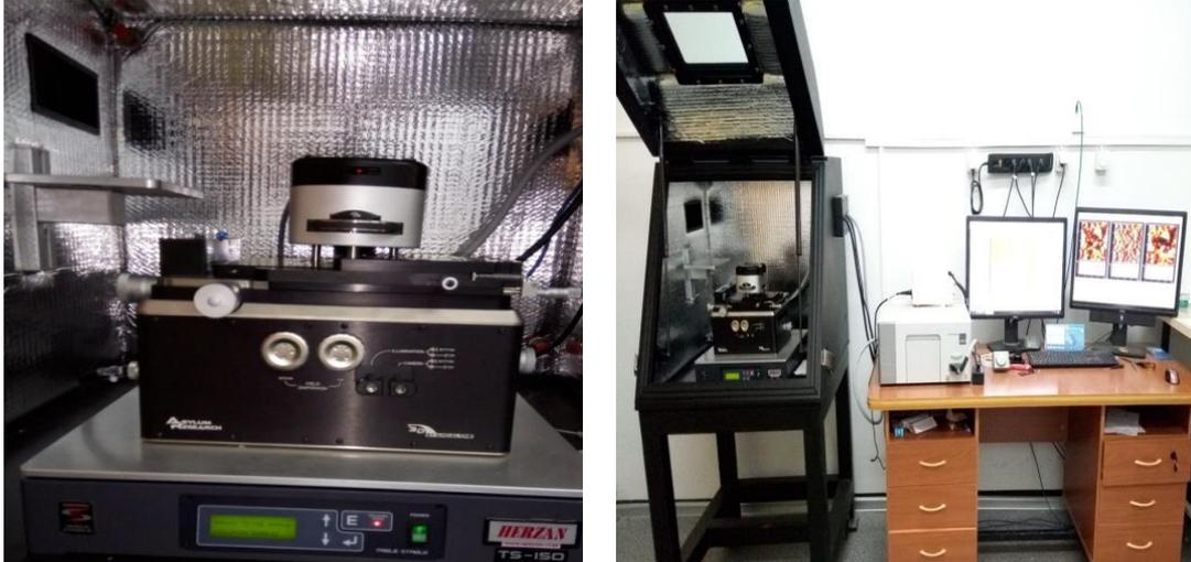
Figure II.10 : Microscope à force atomique
