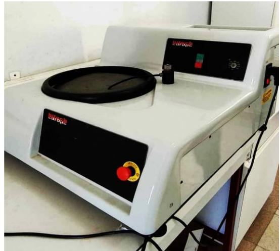
Figure II.15 : Machine de polissage électrique
