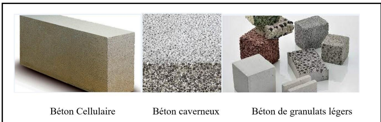
Figure 2 Représentation schématique des différents de bétons légers [7]
