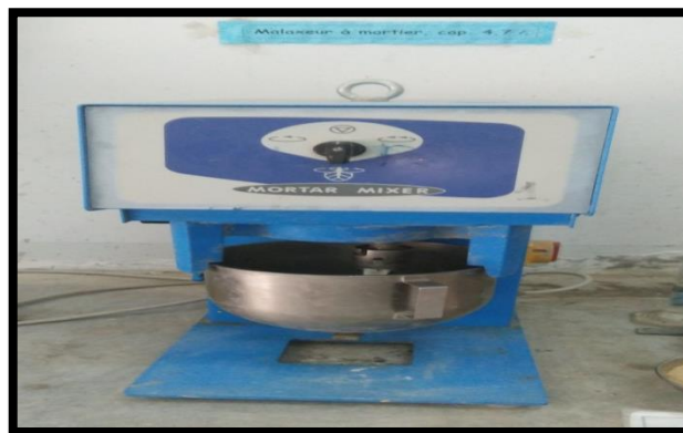
Figure II .5:malaxeur normalisé EN 196-1.
