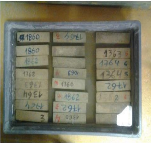
Figure II .16: Mouillage des spécimens dans un bac d'eau potable.
