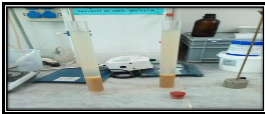
Figure II .3:Essai d'équivalent de sable.
