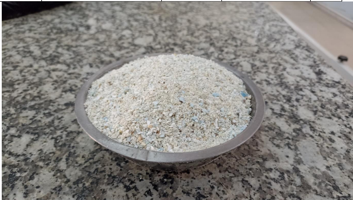
Figure II .6:Granulats de plastiques utilisés.
