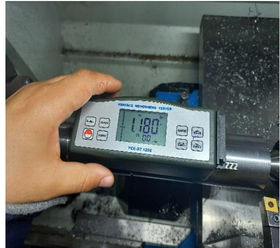
Figure II.10 : Mesure de la rugosité sans démontage de la pièce.
