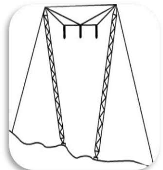
Fig I.10 : Pylône électrique à chaînette
