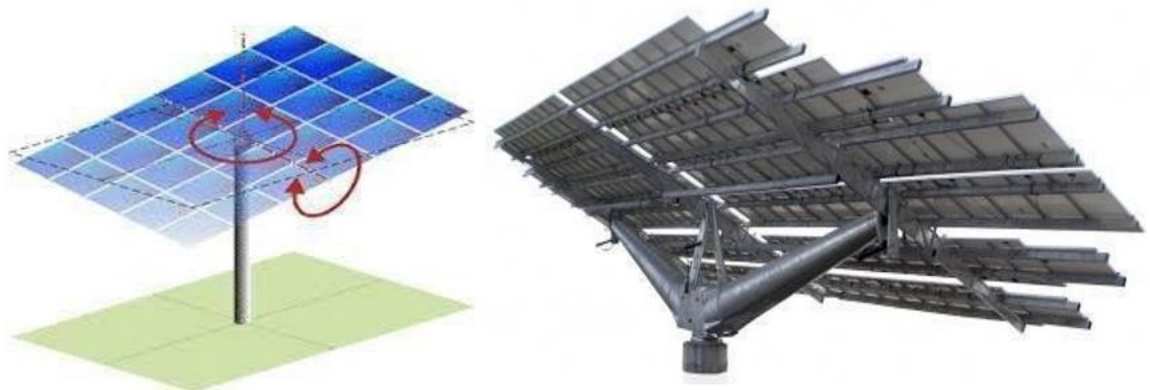
Figure I.12 : Suiveur solaire double axe [1].
