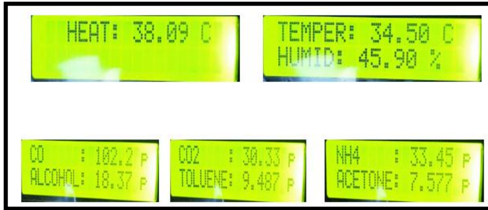
Figure 24. Mesure de température et de qualité de l'air dans le cas d'allumage d'une cigarette
