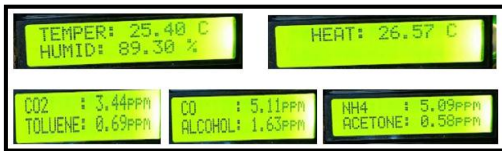
Figure 22. Mesure de température et de qualité de l'air dans le cas de respiration
