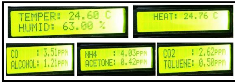
Figure 21. Mesure de température et de qualité de l'air dans le cas normal
