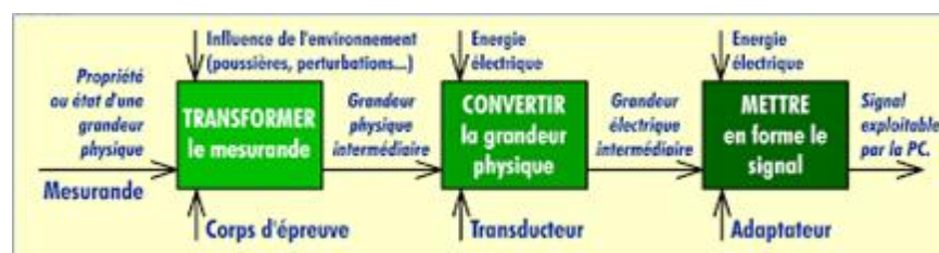
Figure 2. Le principe de fonctionnement d'un capteur industriel
