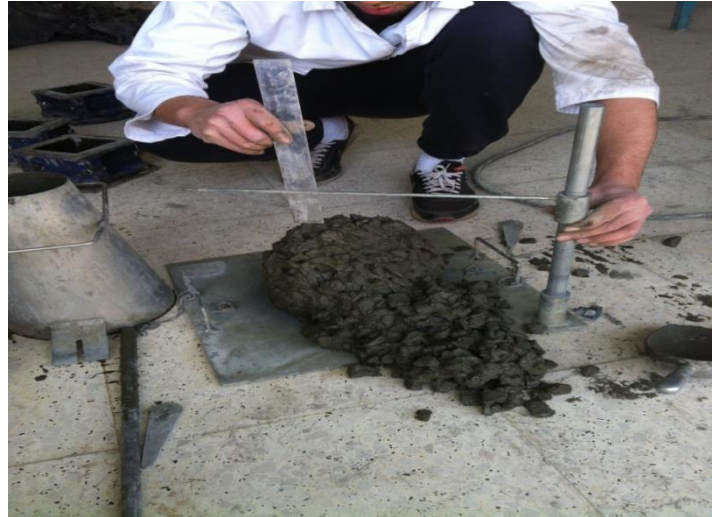
Figure II.15 : Mesure de l'affaissement
