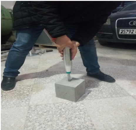
Figure III. 10:Essai scélérométrique (Labo Geo Arif-Setif : juin 2023) + Abaques donnant la résistance de compression en fonction de l'indice scélérométriques IS
