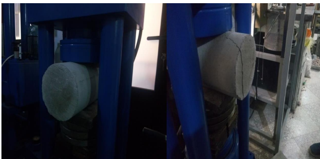
Figure III. 12: Dispositif pour mesurer la résistance à la traction fendage
