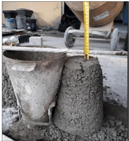
Figure III. 9:l'affaissement de cône d'Abrams d'un béton + Schématisation de l'essai d'affaissement au cône d'Abrams
