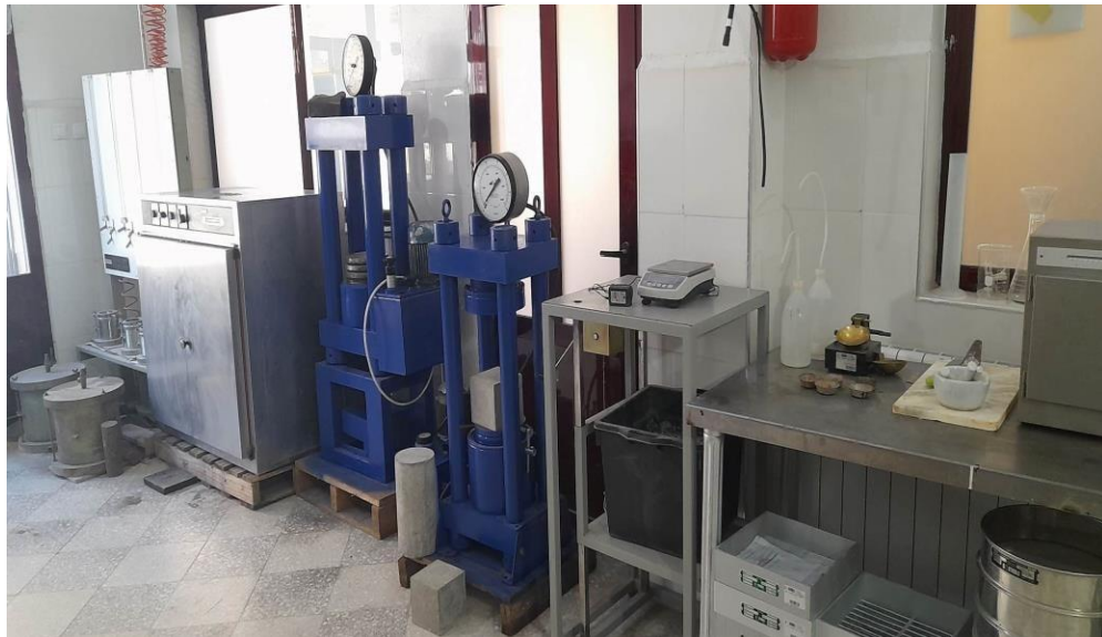
Figure III. 11: La machine pour essai de compression et affichage de la résistance
