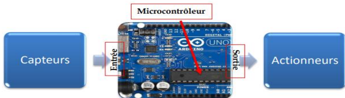
Figure 3. 1 : Fonctionnement d'une carte Arduino Uno.
