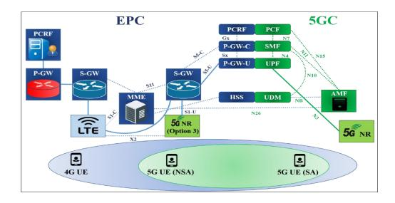
Figure 7. Architecture d'interfonctionnement 4G-5G.
