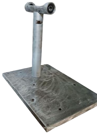
Figure. 38. Soudage de toutes les pièces de base.
