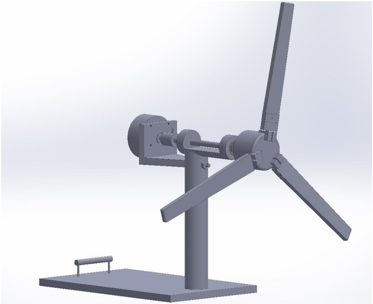
Figure. 35. Conception réalisée de l'éolienne en 3D sur SolidWorks.
