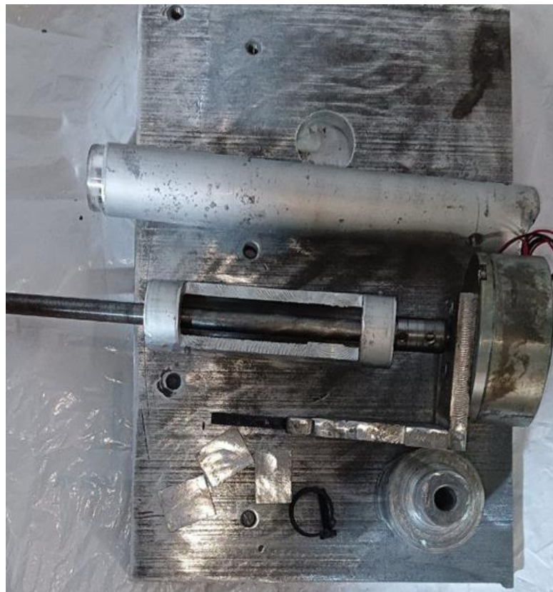
Figure. 37. Découpe de toutes les pièces de base aux dimensions requises.
