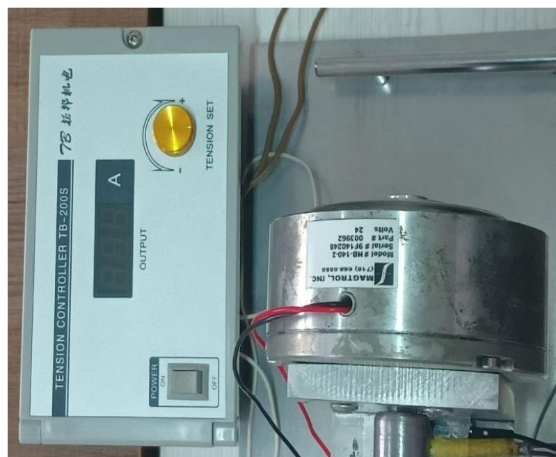
Figure. 41. Câblage électrique du frein électromagnétique et du contrôleur de tension.
