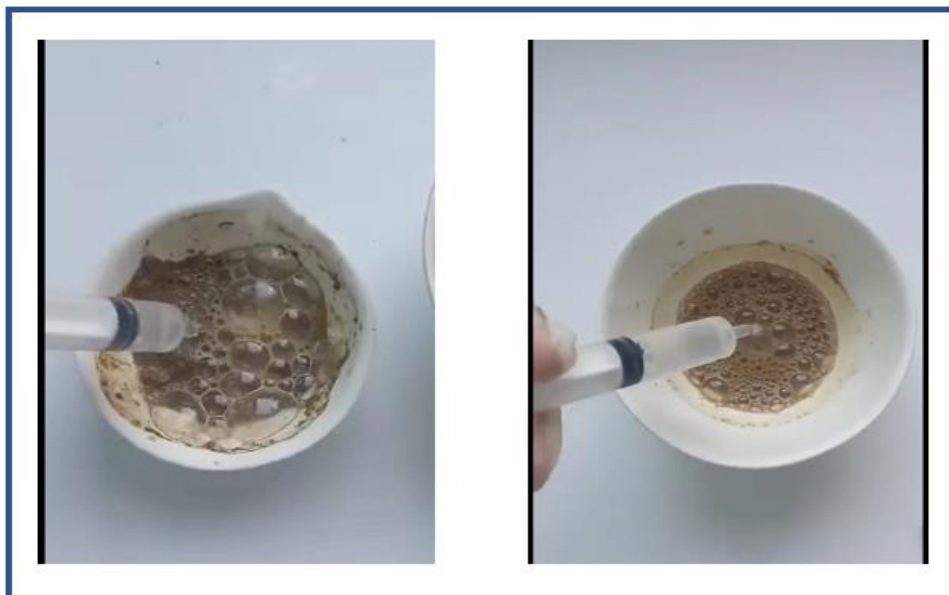
Figure 19. Décarbonation des échantillons de sol
