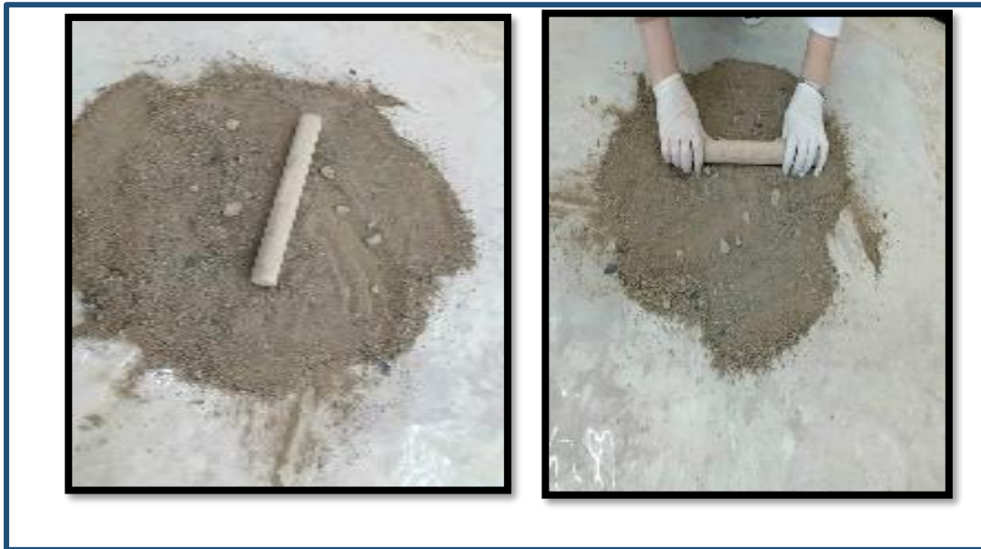
Figure 15. Broyage du sol
