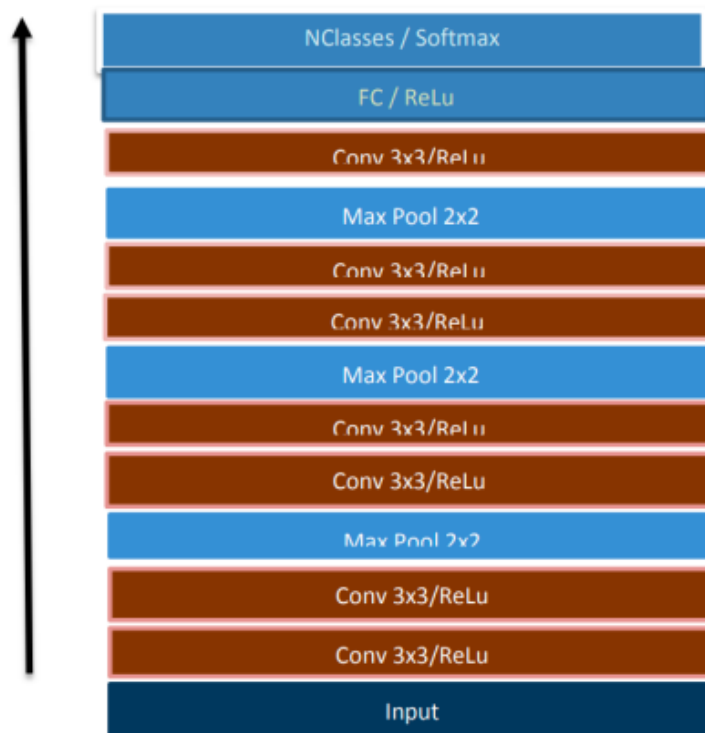
Figure 11: Architecture générale d'un CNN.
