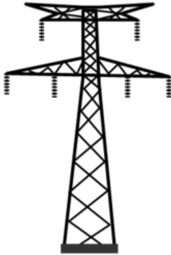
**Figure 1.8:** Schématisation du pylône électrique de type Beaubourg
