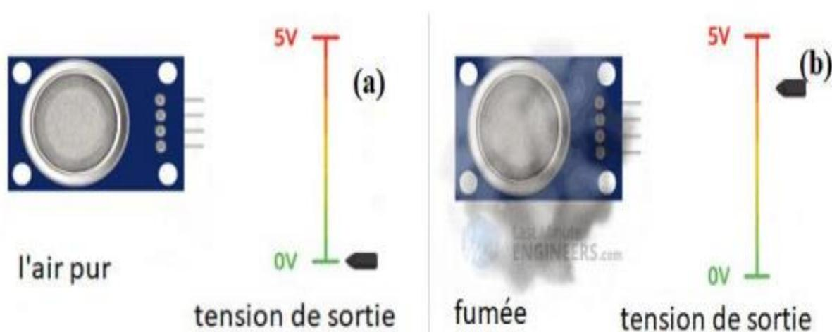
**Figure. 9.** Variation de tension de sortie : a) absence du gaz. b) présence du gaz. [10]
