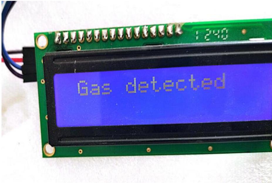
**Figure. 27.** Afficheur LCD 16\*2.
