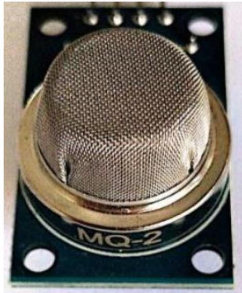
**Figure 8.** Capteur MQ-2.
