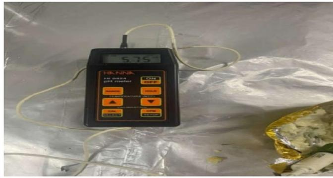
**Figure 5:** Détermination du PH de fromage fondu (photographie originale)
