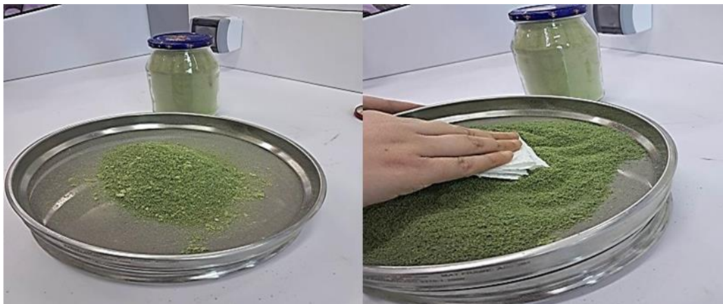
Figure 6 : Opération de tamisage.
