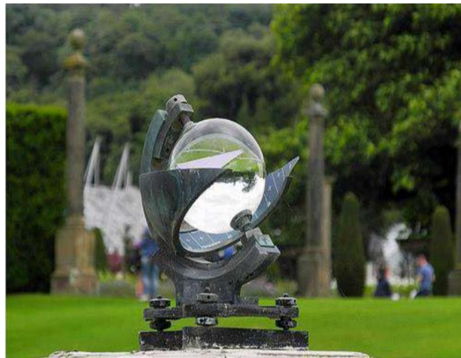
Figure II .7 : L'héliographe de Campbell-Stockes[46]
