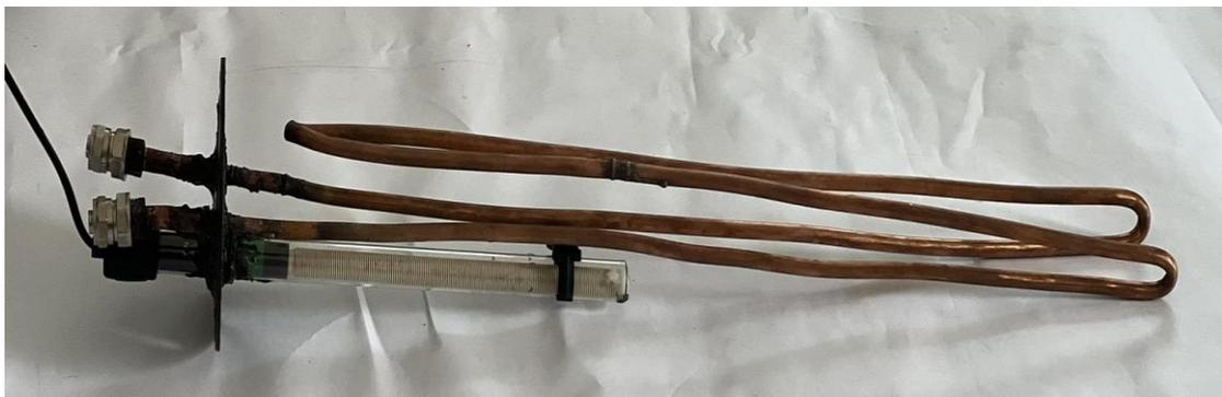
**Figure 11.** *Serpentin et la résistance de chauffage*
