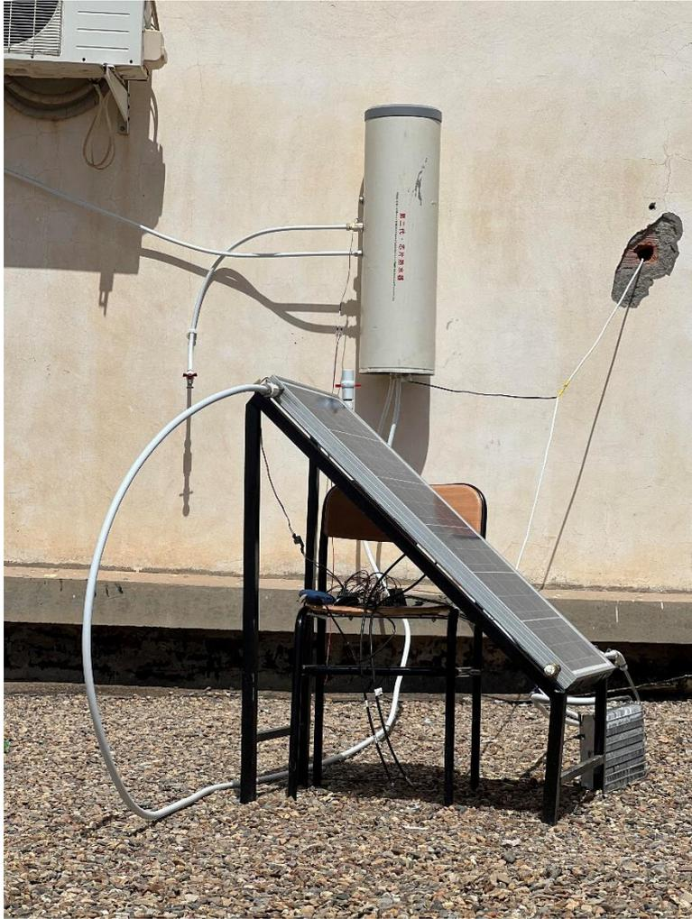
**Figure 16.** *Installation du système hybride automatique PV-T*
