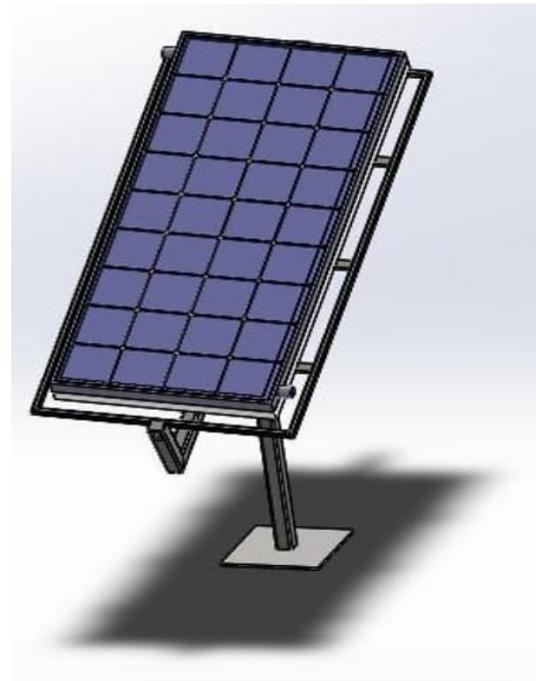
**Figure 2.** *L'assemblage des éléments du système hybride comportant le panneaux PV et le système thermique*
