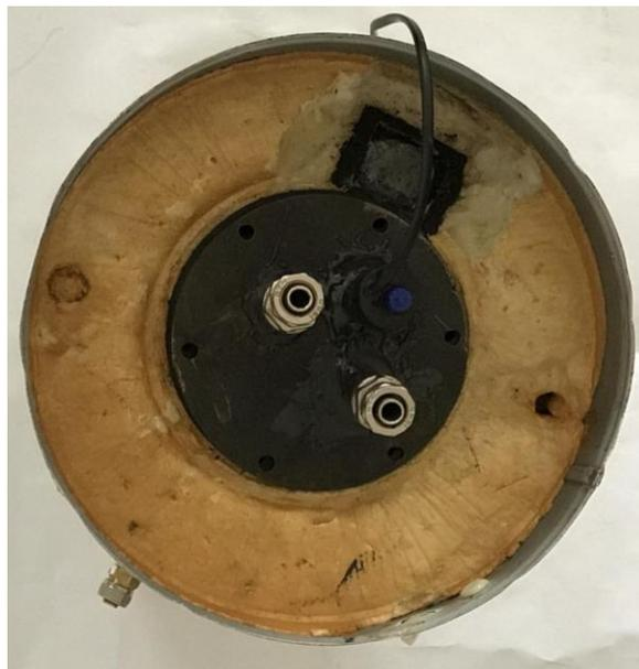
**Figure 13.** *Le réservoir d'eau avec l'entrée et la sortie du liquide caloporteur (serpentin) ainsi que la résistance de chauffage*
