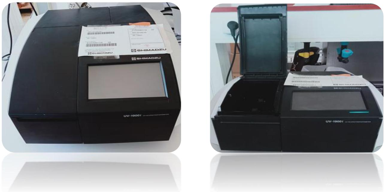
Figure III.1 : spectrophotométrie UV-VISIBLE utilisé (SHIMADZU UV-1900 i).
