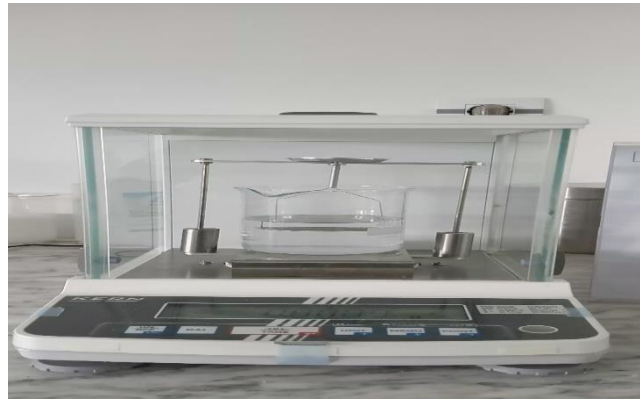
Figures III.3: Machine de test de la masse volumique.
