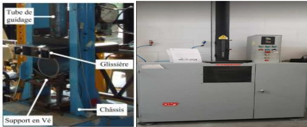
Figures III.2: Machine d'essais de choc.
