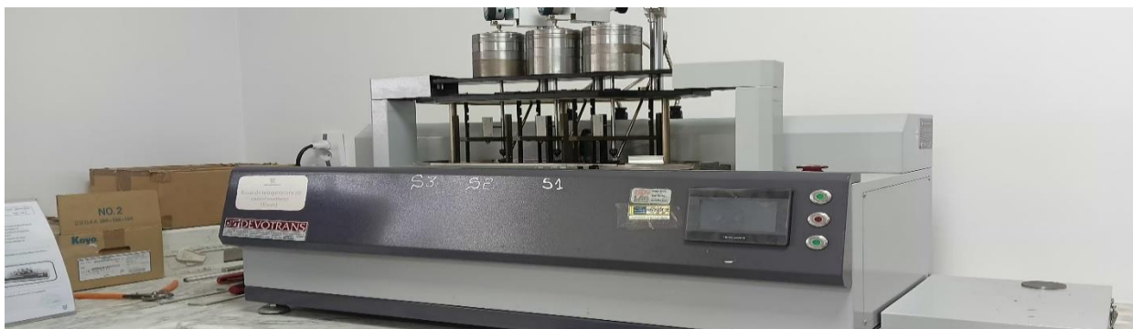
Figure III.4: Machine du test de la température de ramollissement Vicat.
