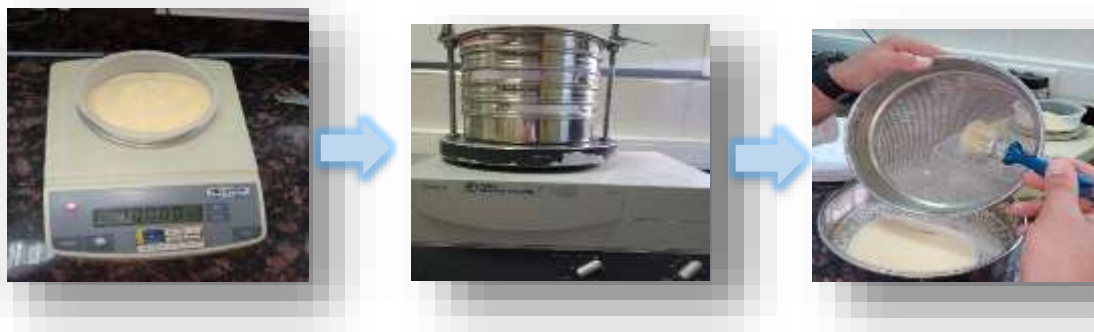
Figure. 25. Détermination de granulométrie avec tamiseur
