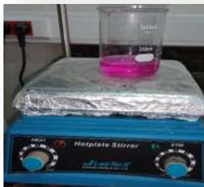
Figure. 36. L'essai de détermination du TA.
