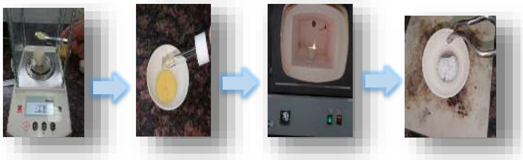
Figure. 27. Détermination de (TC) avec le four à moufle selon la méthode de référence.
