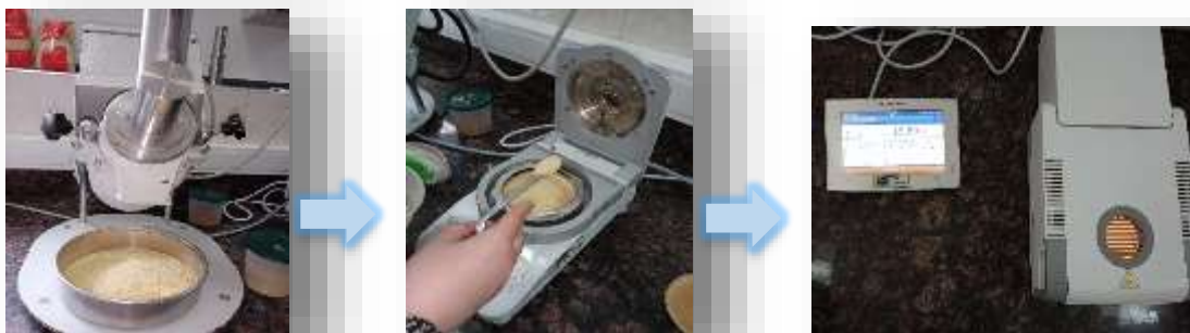
Figure. 26. Détermination de l'humidité avec dessiccateur halogène.
