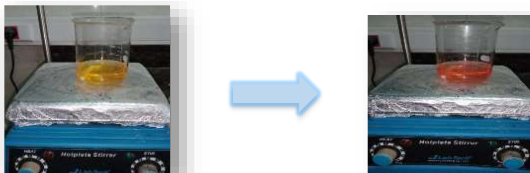
Figure. 37. Virage du couleur du jaune vers rouge brique pour la détermination du TAC.
