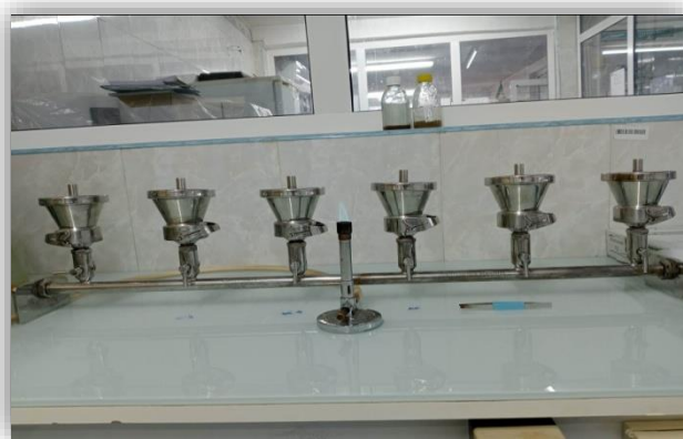
Figure III-11 : Rampe de filtration
