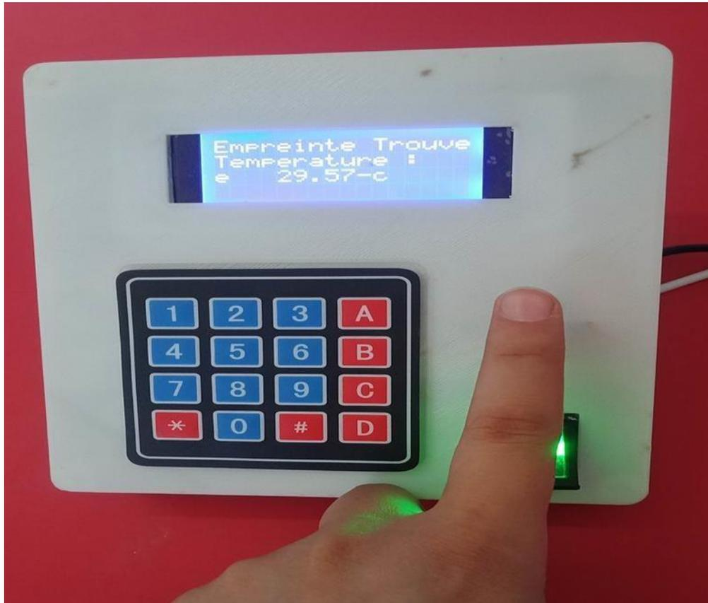
Figure III-20: l'affichage de la température sur l'écran
