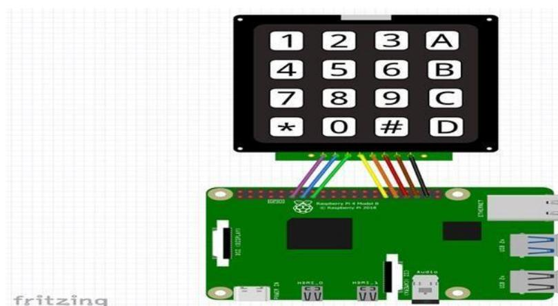
Figure III-3: Brochage clavier matriciel 4x4 avec Raspberry pi
