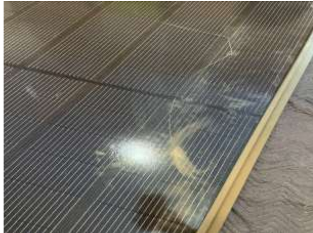
Figure II.20: L'effet de la poussière accumulée sur la cote physique du module PV
