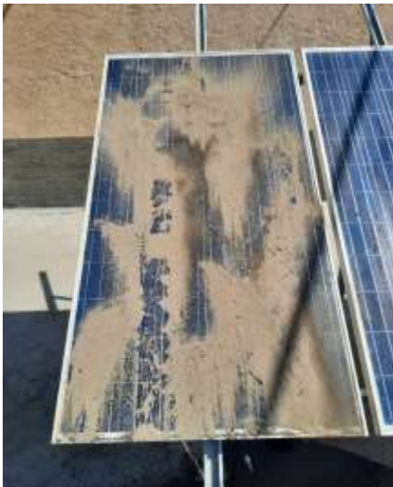
Figure II.51: Panneau solaire avant nettoyage
