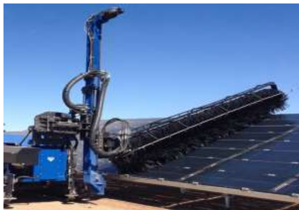
Figure II.24: Nettoyage avec brosse semi-automatique
