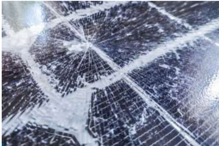
Figure II.6: L'effet des grêlons sur le module PV
