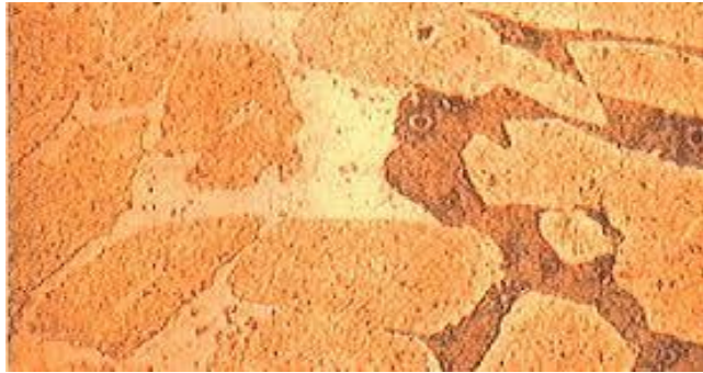
Figure I.7: Coupe métallographique montrant une corrosion sélective d'un laiton
