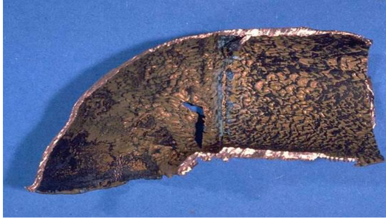
Figure I.8: Corrosion érosion d'un tube en cuivre véhiculant de l'eau [16]
