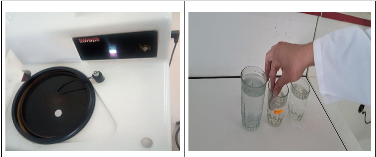
Figure II.2: polisseuse électrique utilisée et rinçage
