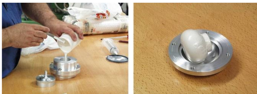
Figure I.13 Fabrication de lentilles par technique de moulage [5].
