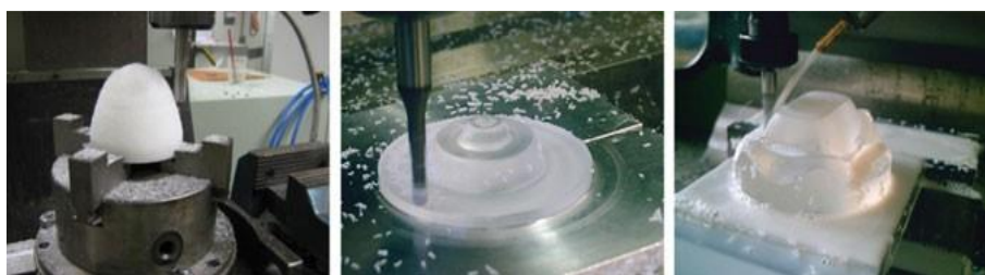
Figure I.12 Fabrication de lentilles par technique de machine CNC [20].
