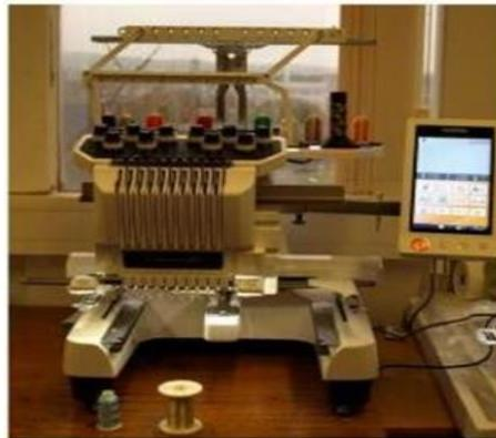
Figure I.14. Machine à broder assistée par ordinateur à l'Université de Loughborough.
