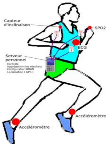
**Figure II.9.** Capteurs utilisés dans le domaine sportif
