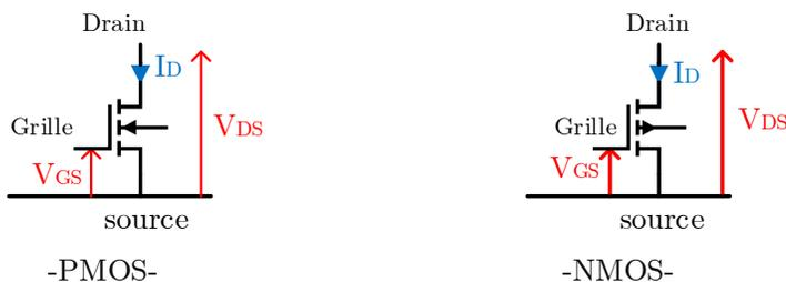
Figure I-12 - Notation pour le PMOS et NMOS
