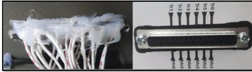
Figure III-16 - La soudure de câble de connexion DP37
