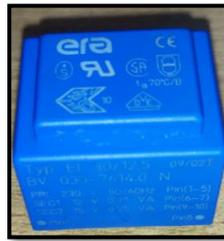
Figure III-18 -Le transformateur 230/2\*15V
