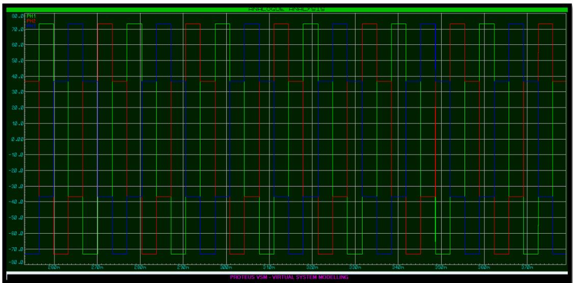
Figure III-7 – Les tensions simples des trois phases pour la commande plein onde
