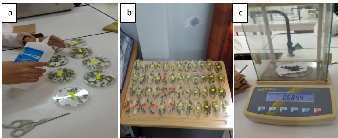
Fig. 13: Les principales étapes à suivre pour déterminer la teneur en eau (Originale, 2019).
