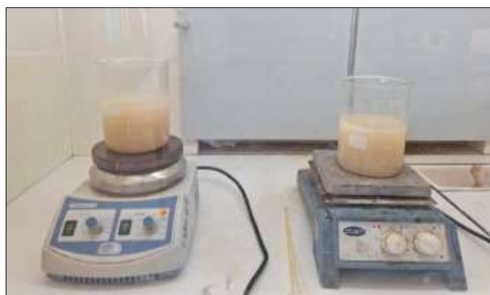
Figure 2.6. Traitement blanchiment des fibres de palmier dattier.
