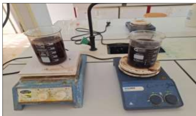
Figure 2.5. Traitement alcalin des fibres de palmier dattier.
