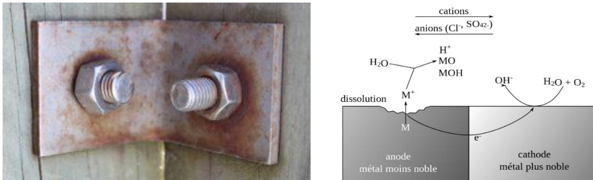
Figure I.5 : Corrosion galvanique et son mécanisme.
