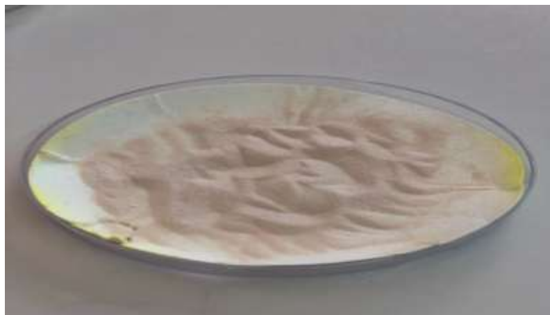
Figure II.12: Image montrant le filtrat récupère de la réaction de fixation de la Fluorescéine sur du PVC fonctionnalisée. a) Filtration du mélange de réaction b) Produit récupéré après filtration, lavage et séchage.
