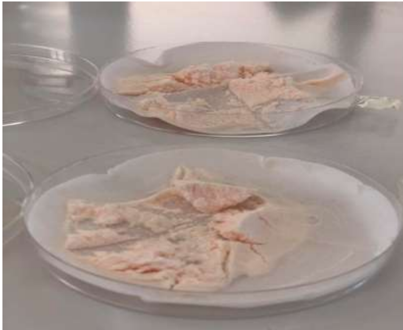
Figure II.9: Photo montrant le processus de récupération du PVC réticulé.
