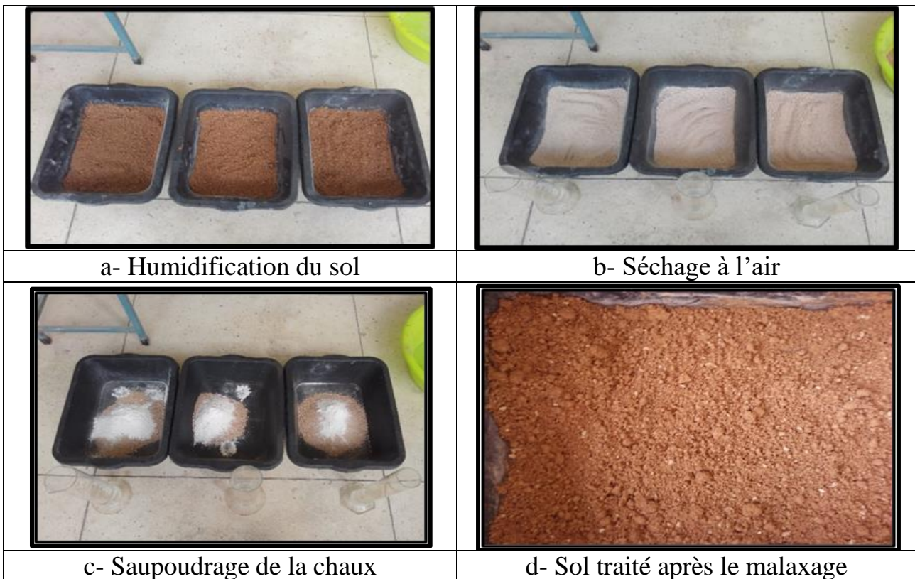
Figure II. 1: Préparation du sol traité. (Maafi. N, 2020)
