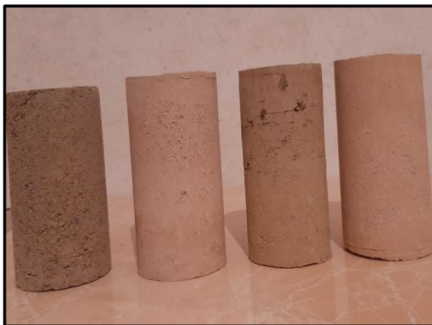
Éprouvettes 10X10 pour l'essai de compression simple au mode de cure normale
