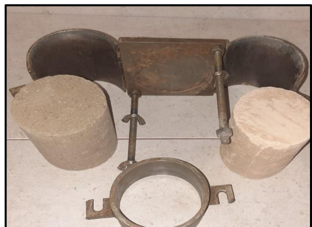
Éprouvettes pour l'essai de cycle séchage-humidification
