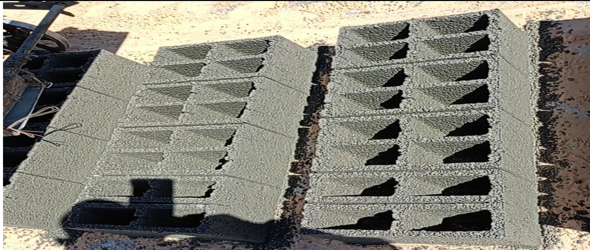
Figure.II.3. Les étapes de préparation de bloc de béton de caoutchouc pour les dosages en m 3 (sable = 540 kg ; ciment = 380 kgm ; gravier 3/8= 1800 kg ; eau = 160 kg)
