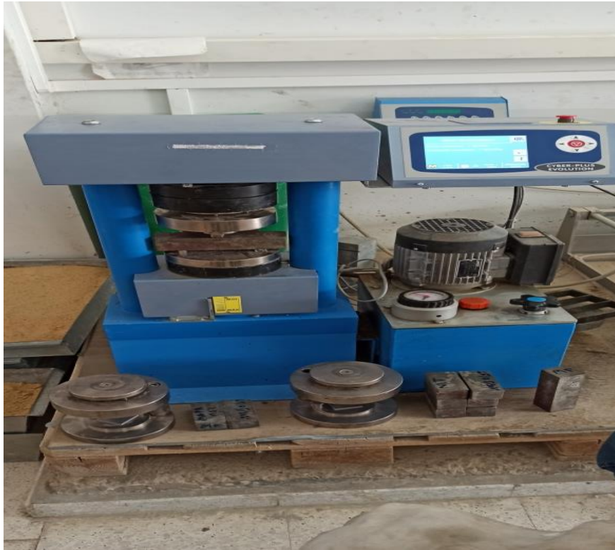
Figure. II.9 : Dispositif expérimental de l'essai de flexion
