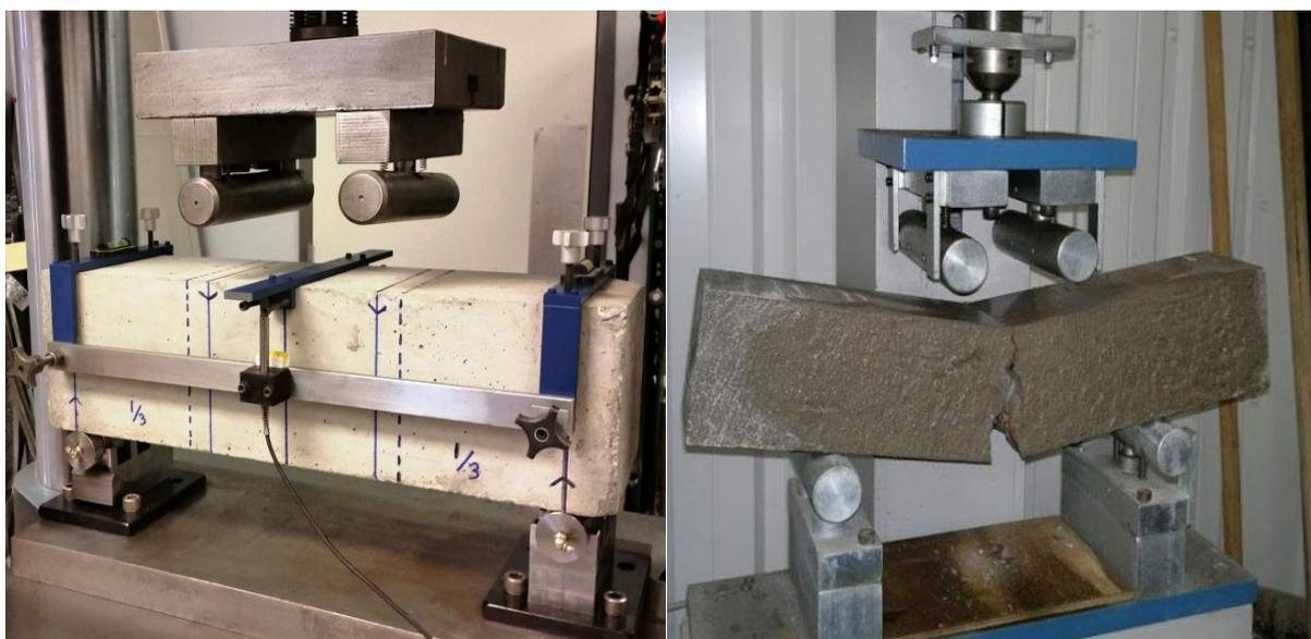
Figure 13 : Essais de flexion à quatre points sur des échantillons de béton.
