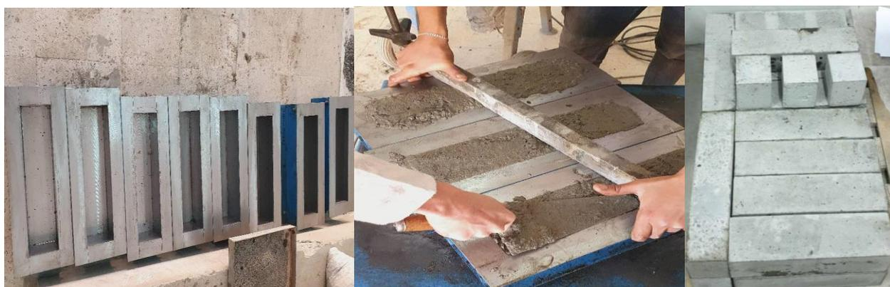
Figure 38 : Réalisations des éprouvettes en béton.
