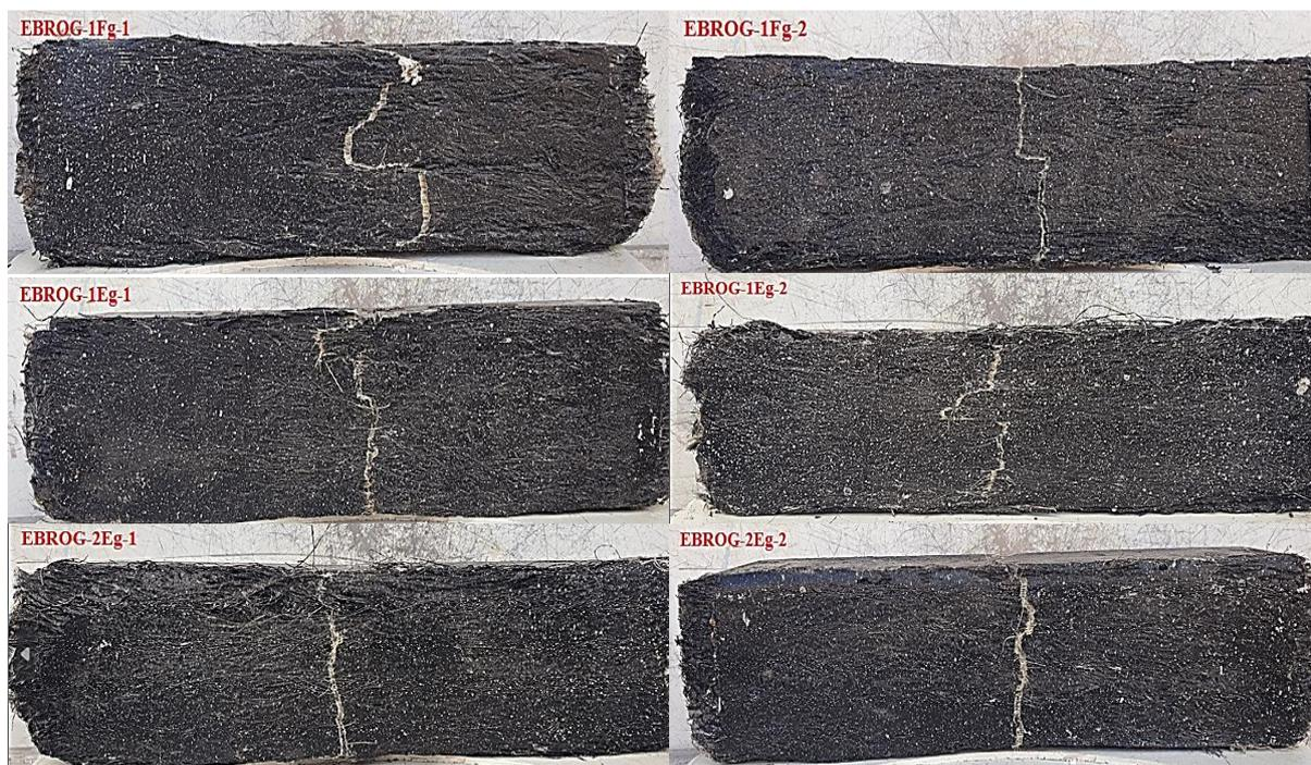
Figure 45 : Mécanismes de défaillance des échantillons du groupe 2 et 3.
