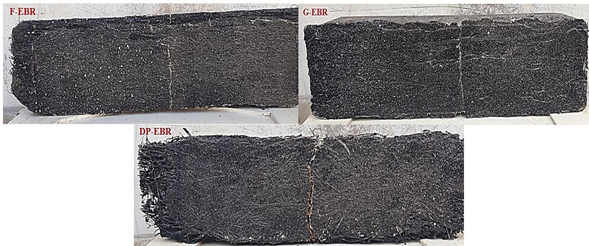
Figure 44 : Mécanismes de défaillance des échantillons du groupe 1.
