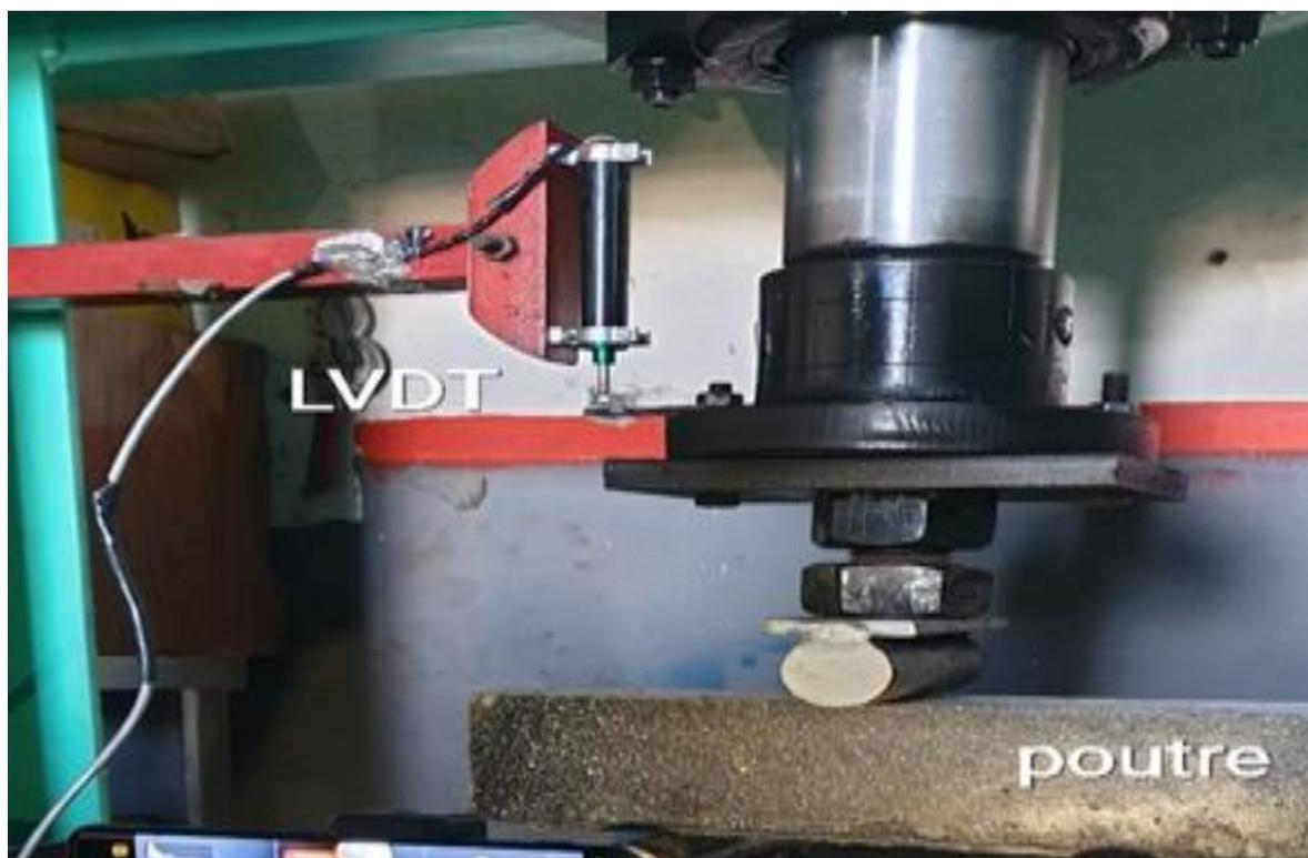
Figure 40 : Configuration expérimentale pour la mesure de déformation.
