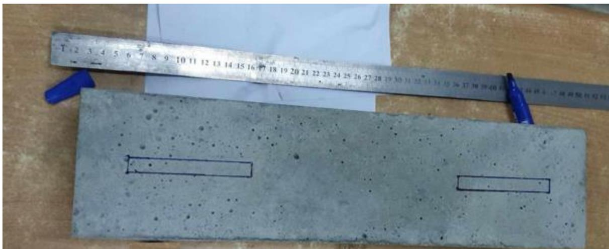
Figure 44 : Marquage des poutres pour la réalisation des rainures.
