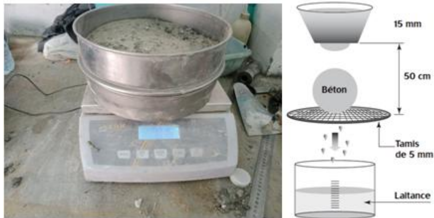
Figure III.6. L'essai Stabilité au tamis (laboratoire de GC)
