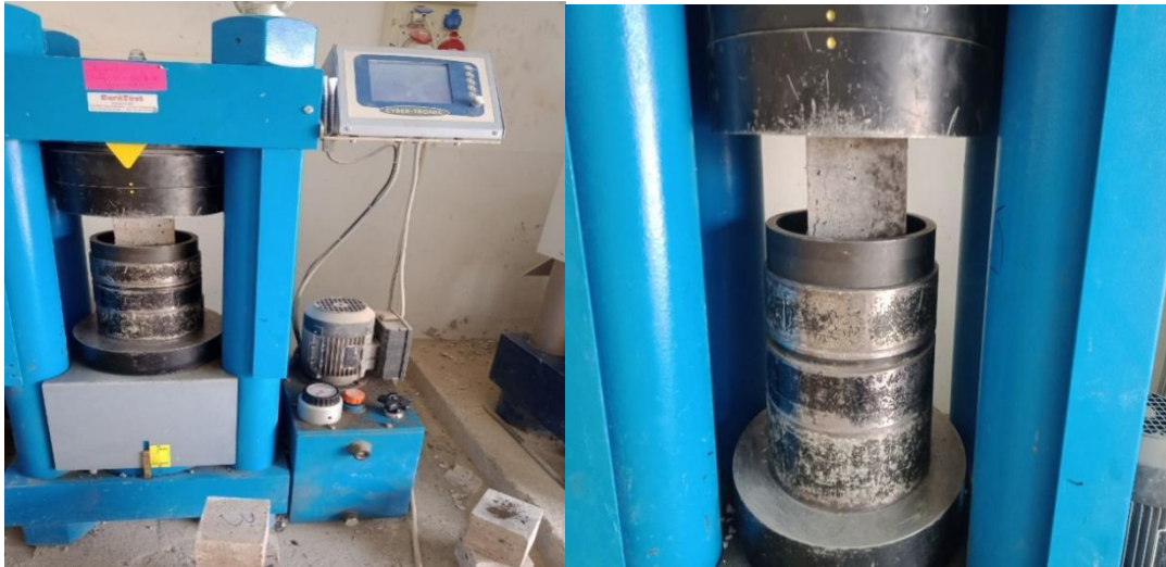
Figure III.8. L'essai de compression (laboratoire de GC)
