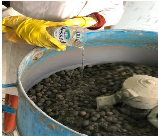
Figure III.26 : Verser le mélange eau/super plastifiant
