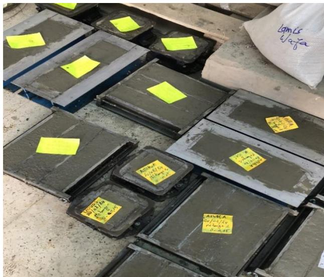
Figure III.29 : Les moules après coulage du béton
