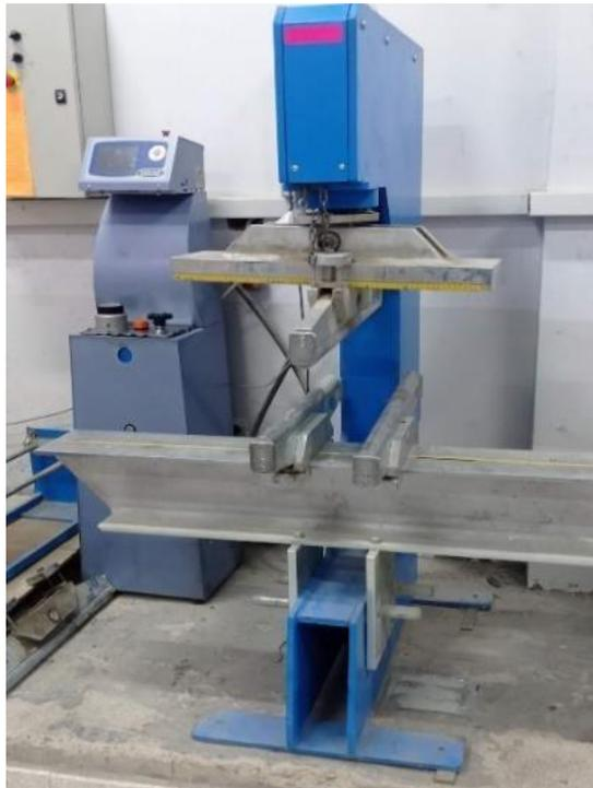
**Figure IV.44 : Machine de mesurer la résistance à la flexion**
