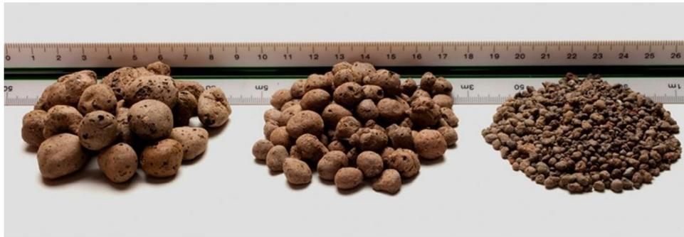
Figure II.6 : Différentes granulométries de l'argile expansée [13]
