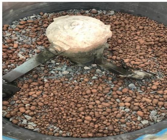
Figure III.24 : Malaxage des granulats à sec
