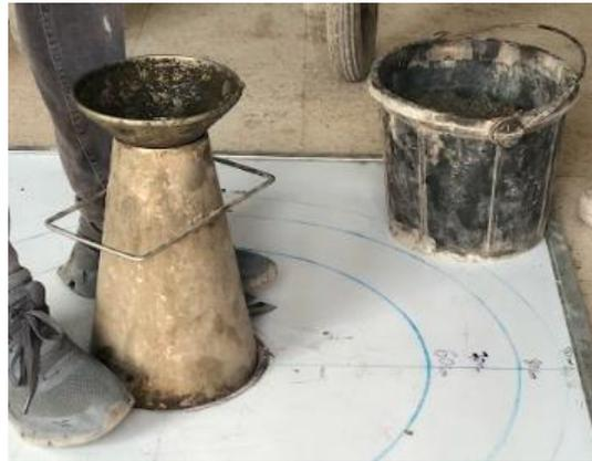
Figure IV.32 : L'essai de l'affaissement au cône d'Abrams
