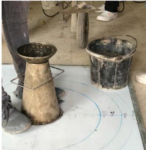
Figure III.28 : Essai d'affaissement au cône d'Abrams
