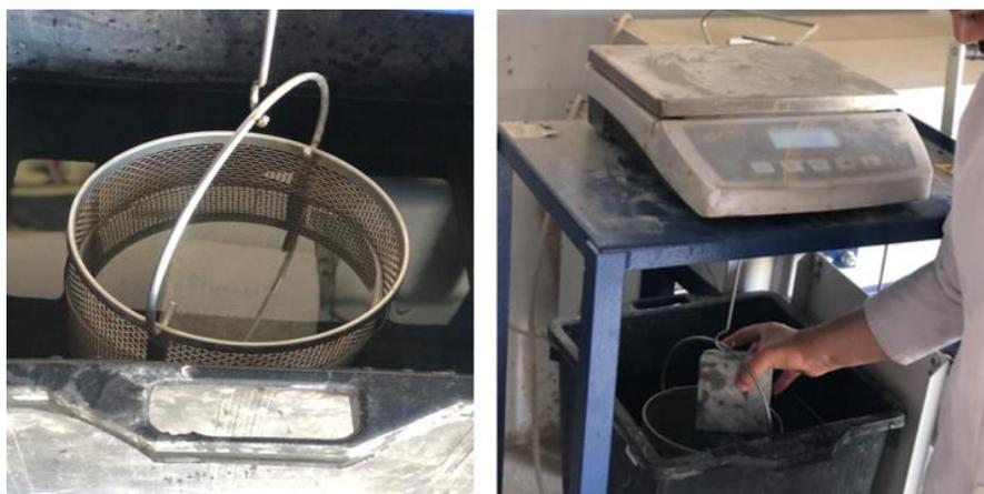
Figure IV.47 : Balance hydrostatique
