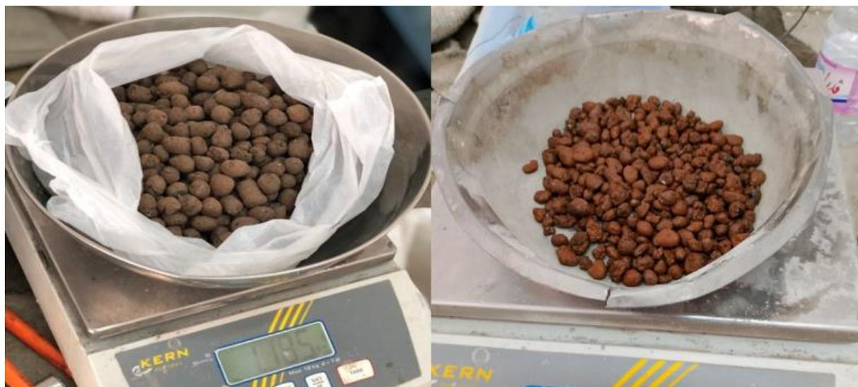
Figure III.17 : Granulat d'argile expansée 3/8 mm et 8/15.
