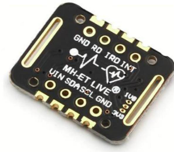
Figure II.4 Le capteur MAX30102
