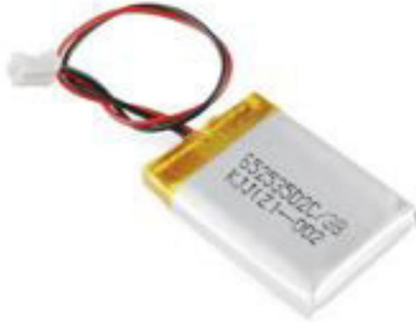
Figure II.7 La batterie lithium-polymère (LiPo) de 3,7 V
