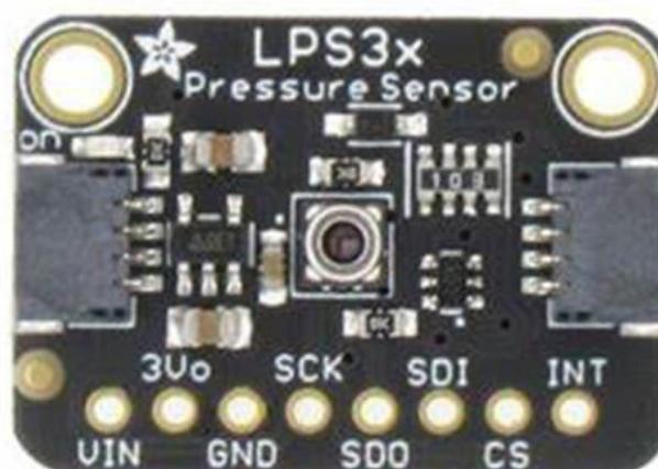
Figure II.6 Le capteur LPS33HW.
